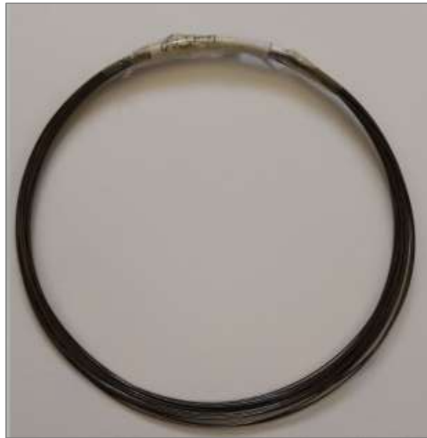
Figure 7.8. Alliage à mémoire de forme (NiTi). Source : Auteur (2022).
