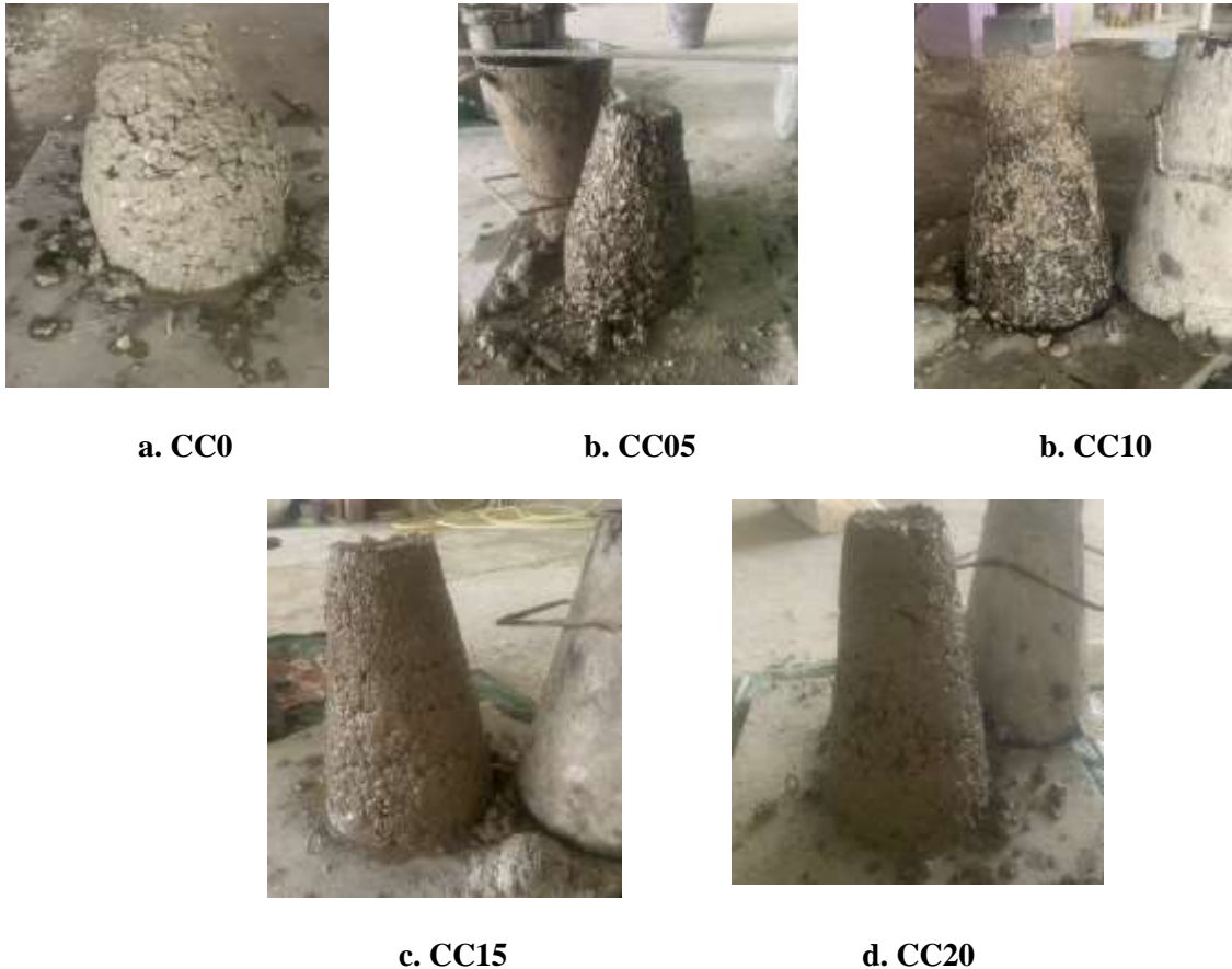
Figure 6.23 : Résultats d'Essais d'affaissement pour les mélanges étudiés
