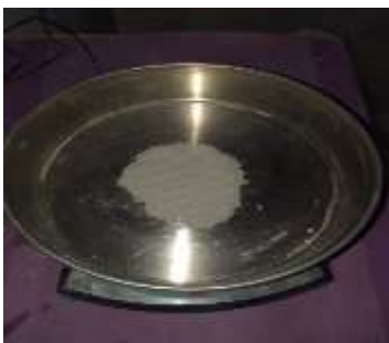
Mesure de la masse du sable
