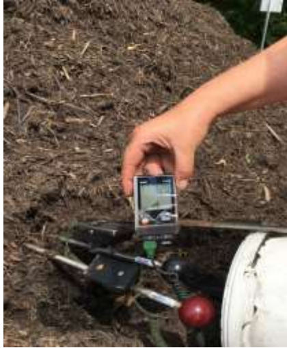
Figure 6.6 : Mesure de la température dans le tas de compost Source : auteur 2022
