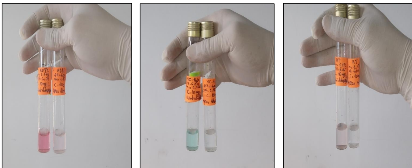
Figure 4.35: Tests expérimentaux de bio-adsorption des colorants RD81, RT et VC-H3G dans les conditions optimales : C_0=10 mg/L, pH=6.04 , m=1.17 g, t=60 min, T=22^\circ C .
