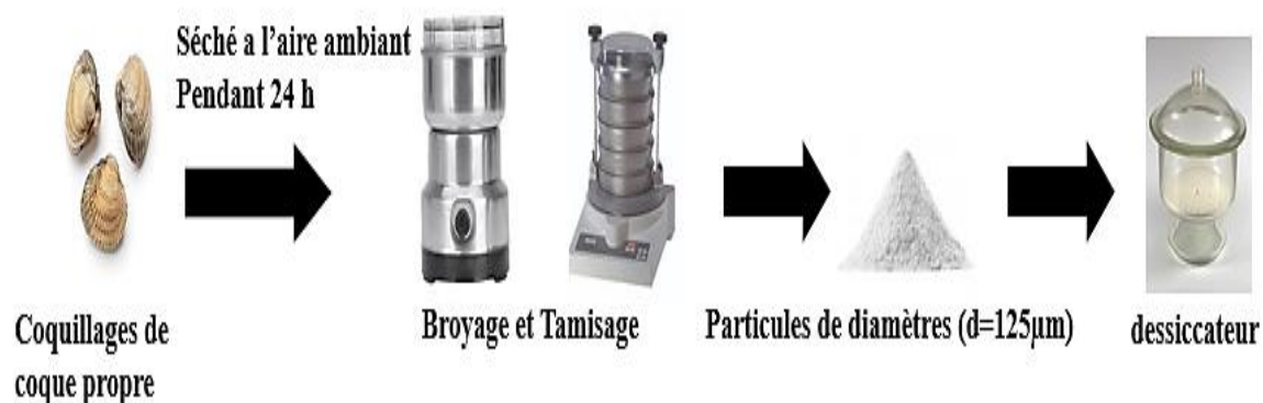
Figure 2.4: Etapes de préparation du bio-adsorbant à partir de la coquille de coque.
