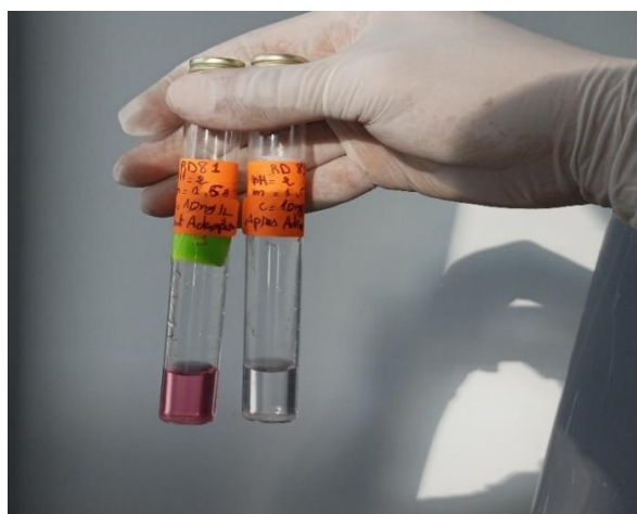
Figure 4.30: Expérience de bio-adsorption du colorant RD 81 avec les conditions optimale : C_0=10 \text{ mg/L} , \text{pH}=2 , m=1.5 , t =60 \text{ min} , T=22^\circ\text{C} .
