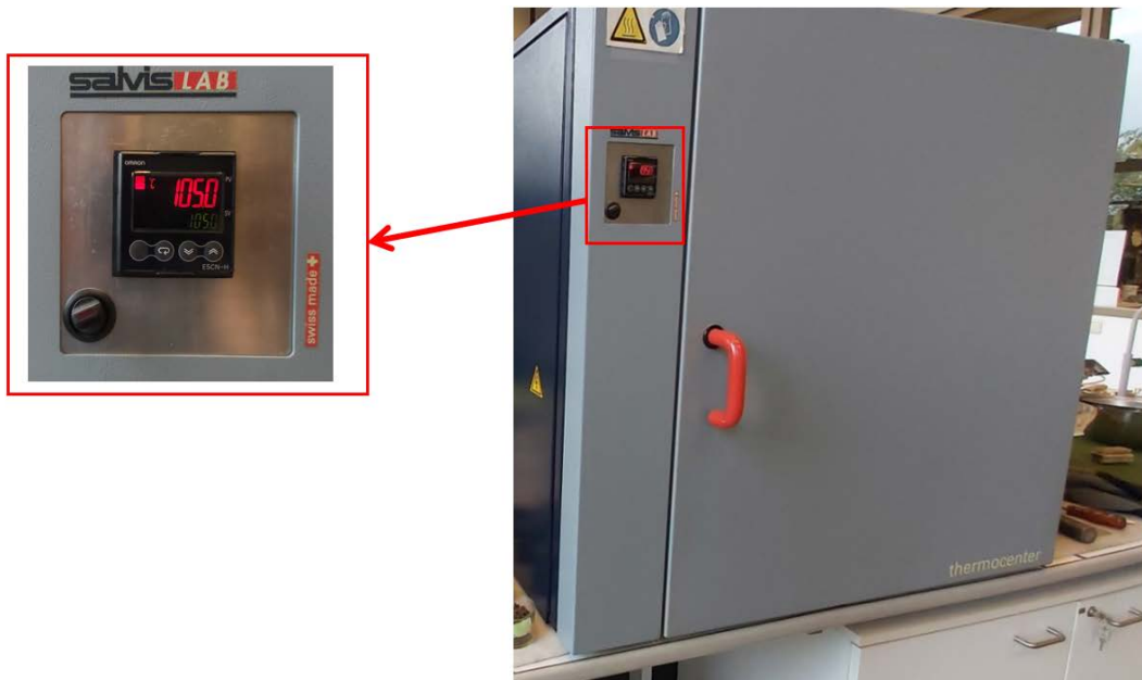
Figure 2. 19 : Four pour le séchage des échantillons de la paroi à 105 °c.
