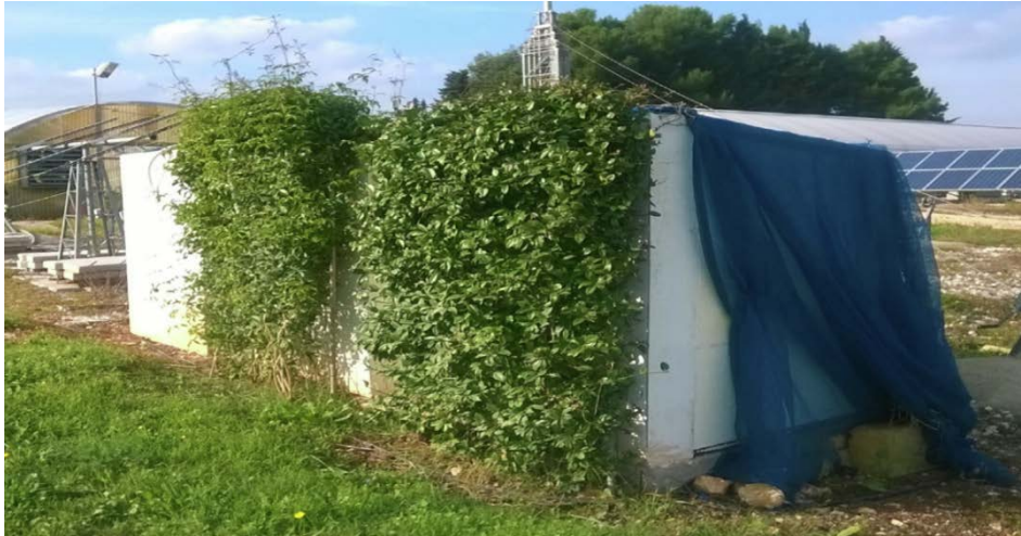
Figure 3. 11 : Box de mesures avec différentes densités végétales, proposé par Blanco et al. (source : Blanco et al. 2019)
