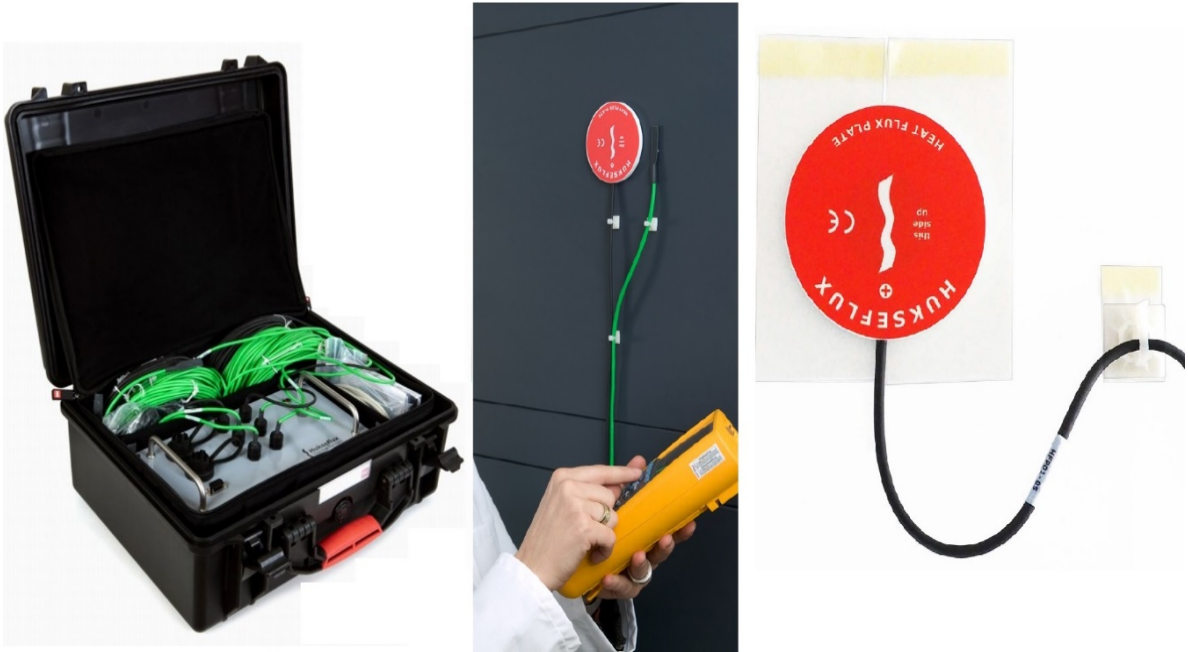
Figure 2. 16 : Dispositifs de mesure du transfert de chaleur dans le mur.
