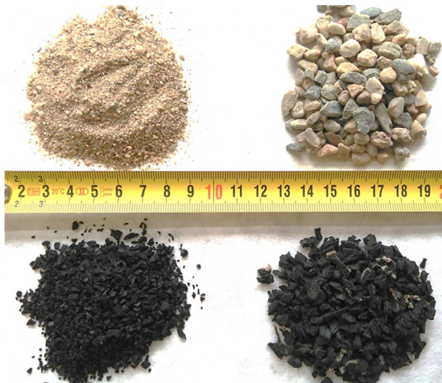
Figure 3.10 : Agrégats naturels et à base de caoutchouc proposés par Záleská et al.
