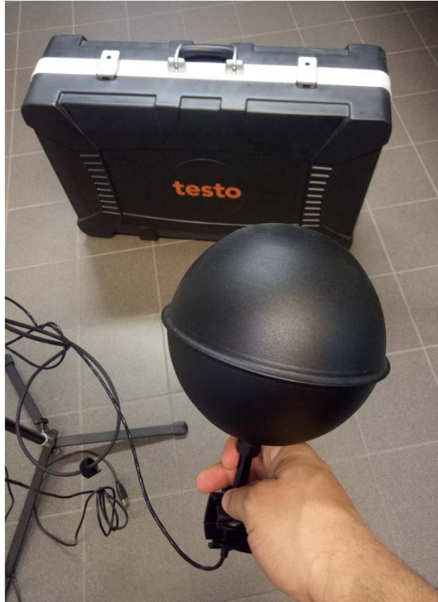
Figure 2. 11 : Capteur de la température de globe avec une thermistance à l'intérieur.
