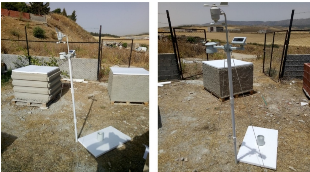
Figure 4. 17 : Station météo type Oregon Scientific (source : Éditée par l'auteur, 2020)
