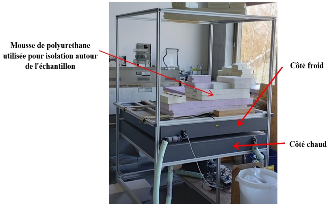
Figure 2. 17 : Dispositifs de mesure du transfert d'humidité dans le mur.
