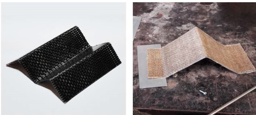
Figure 3. 8 : Revêtement composite à base de SEBS avec un tissu de fibres de carbone, proposé par Rodonò et al. (source : Rodonò et al. 2019)
