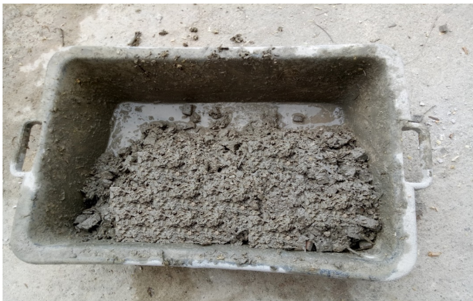
Figure 4. 12 : Préparation de la texture rugueuse du revêtement extérieur avec des particules de palmier (source : Éditée par l'auteur, 2020)
