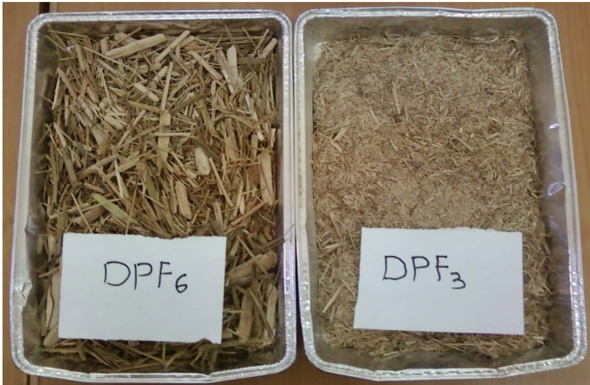
Figure 3. 9 : Particules de palmier de différentes tailles, proposé par Benmansour et al.
