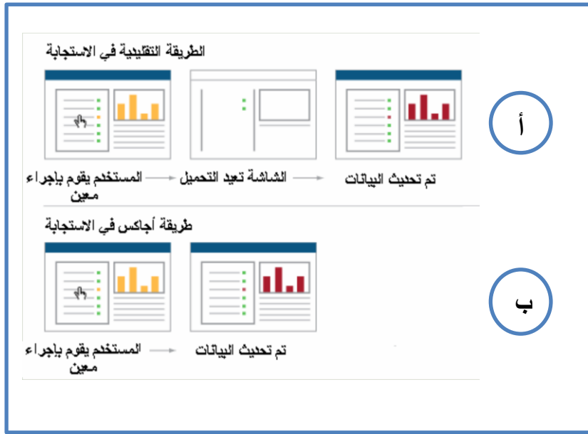
شكل (27) يوضح الفرق بين الطريقة التقليدية في الاستجابة لطلب المستخدم في المواقع العادية (أ) وطريقة تقنية أجاكس (ب) (29)
