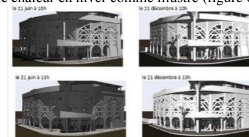
Figure 6.62 étude de l'ensoleillement entre l'été et l'hiver, source bureau d'étude Smail Mellaoui, aout
