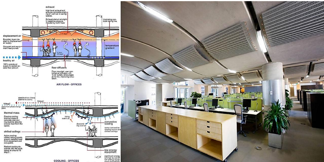
Fig.II.23 schéma de fonctionnement des systèmes de rafraîchissement et de renouvellement de l'air et vue intérieure des bureaux du bâtiment CH2 (Source: www.mickpearce.com)
