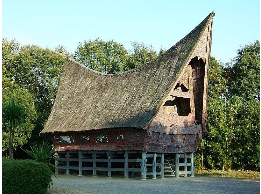
Fig.III.2 Bâtiments indigènes élevés sur pilotis avec des toits élevés et des pignons ouverts pour maximiser la ventilation naturelle à Sumatra, en Indonésie
