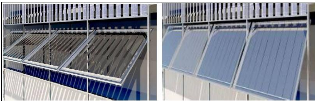
Fig.III.10 : Le prototype final proposé avec l'intégration d'un système photovoltaïque (Source : Kensek et Hansanuwat, 2011)
