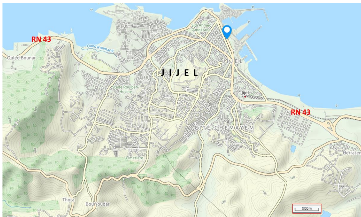
Figure 1.18 : ACL de Jijel : un trafic supporté par les radiales ou pénétrantes, en l'absence de tangentiels ou rocades, provoquant une congestion du centre.
