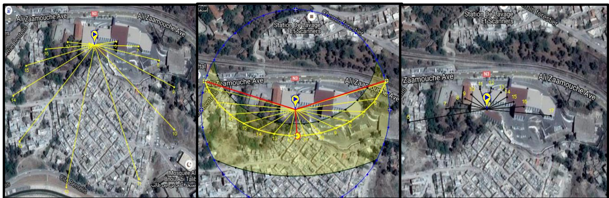
Fig-III-4- Présentation de la course solaire horizontale les zones ensoleillées et ombrées en été. (Source) : [ http://users.telenet.be/h-consult/soleil/afstand_panelenZ.htm ]18/08/2016.].
