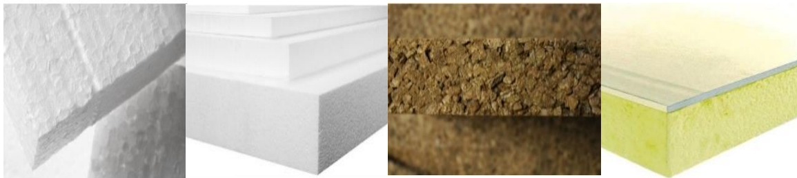
Fig-I-8 : De gauche à droite, polystyrène EPS, polystyrène XPS, liège, et polyuréthane. (Source : Thiery Gallauzuax 2015).
