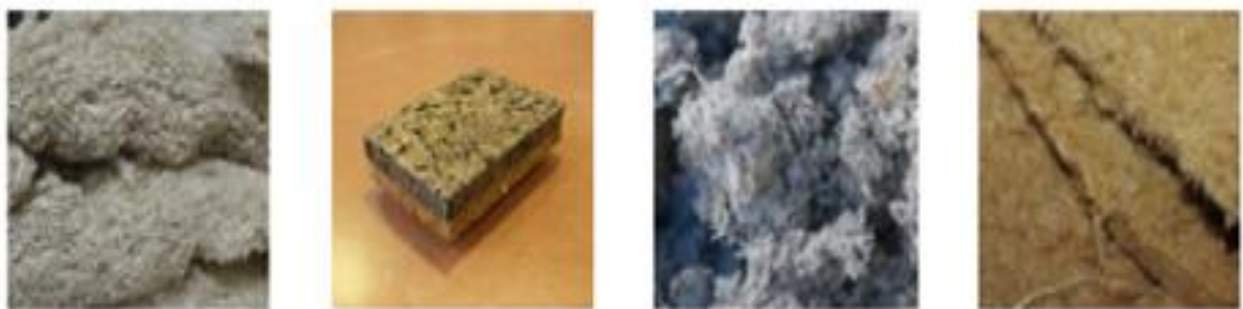
Fig.I.11: De gauche à droite, laine de mouton, liège et fibre de coco, ouate de cellulose, et chanvre. (Source : Thierry Gallauzuax 2015).
