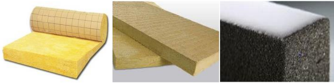
Fig.I-5. : De gauche à droite, laine de verre, laine de roche, et cellulose (Source : Benjeddou, O et al 2016 ).
