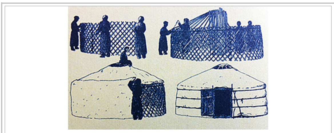
Figure 18: Croquis illustrant la structure d'une yourte
