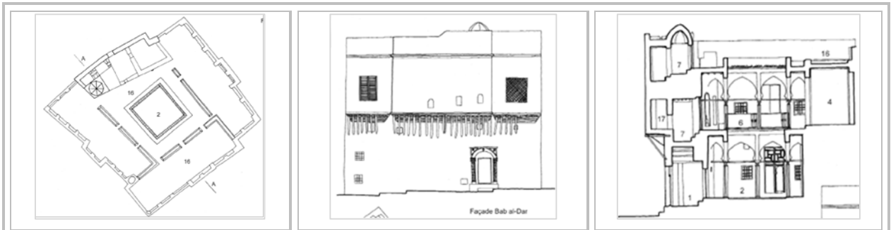
Figure 56 : Maison 02 avec wast al dar , Sidi Driss Hamidouche
