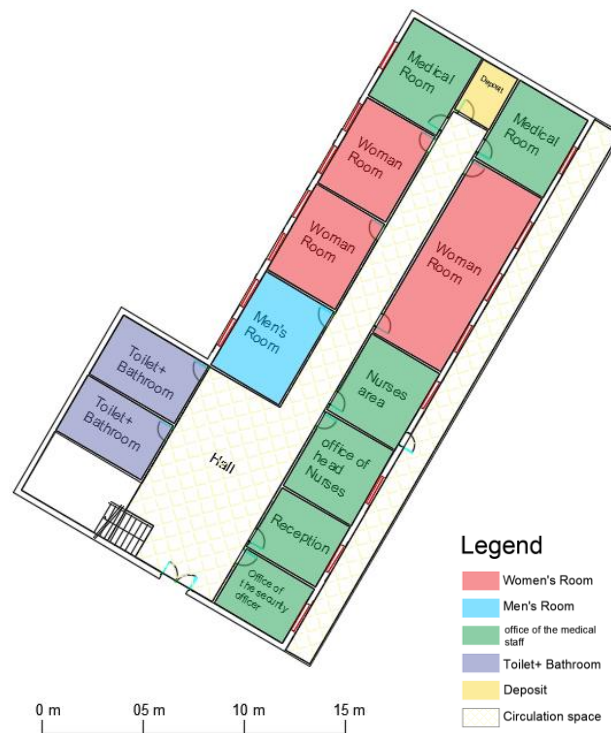
Figure 3. 23: Plan de distribution de l'unité d'hébergement du service de neurologie du CHU d'Annaba. Source : (Talentikite and Bencherif, 2021).
