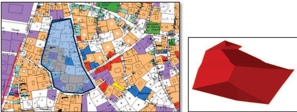
Fig. E. 6 : Étendue et enveloppe solaire de l'agrégat (îlot) de la maison cas d'étude. (Source : PPSMVSS)
