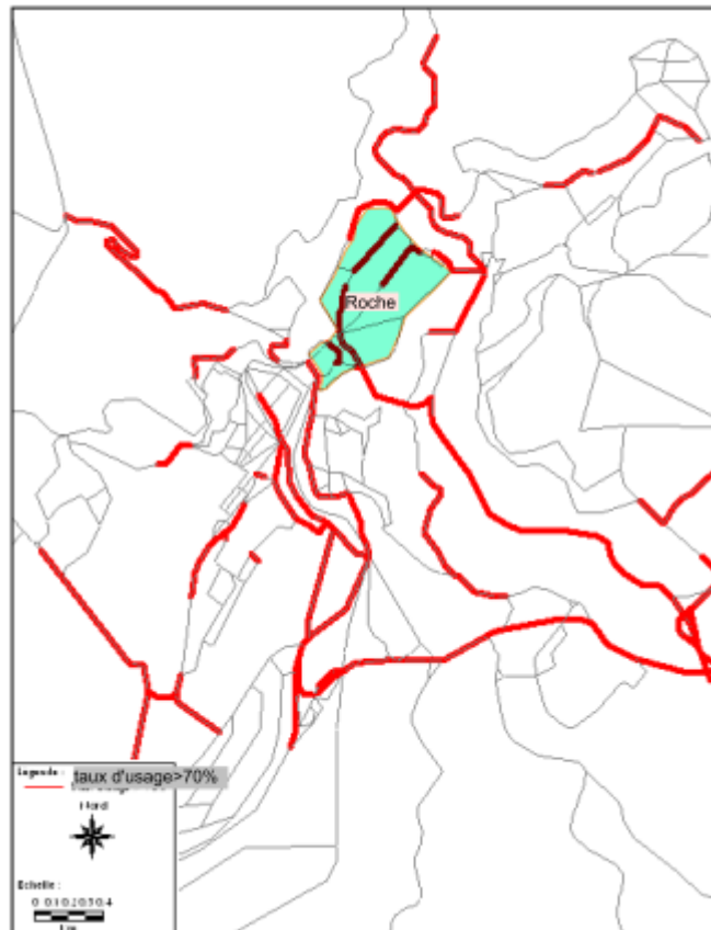
Carte 34 : Taux d'usage du réseau routier (zoom sur le centre de Constantine) (Source : Etude de faisabilité d'une ligne de tramway à Constantine - FSP revitalisation du centre de Constantine, EMA / BETUR-INGEROP. 2005)
