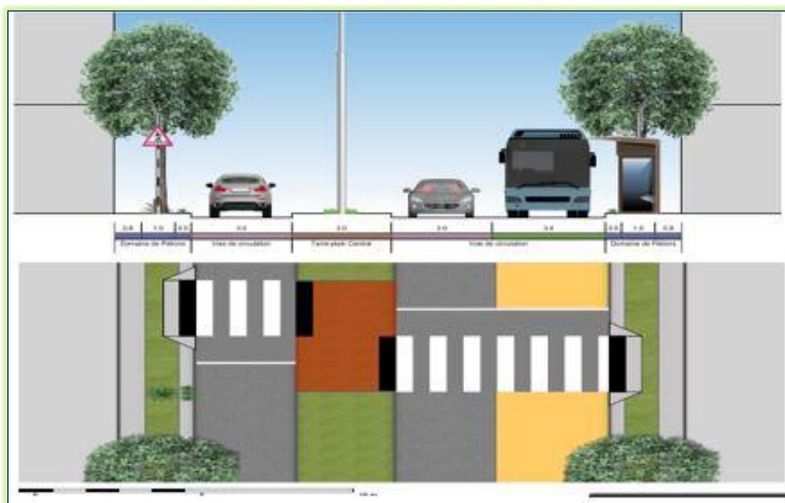
**Figure 47 : Vue en coupe de Boulevard Sud après l'insertion d'une ligne de Bus**
