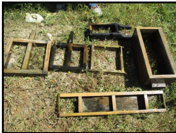
Photo 3.10 : Le coffrage de bois ou « El Kaleb »
