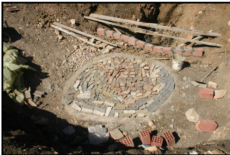
Photo 3.32 : Les briques stockées dans la chambre de cuisson
