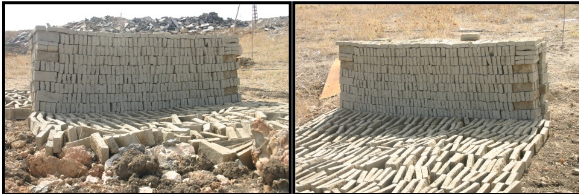
Photo 3.17 : Le stockage des briques crues à l'air libre
