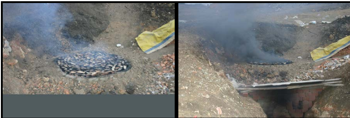
Photo 3.34 : Le changement de la couleur de la fumée pendant la cuisson
