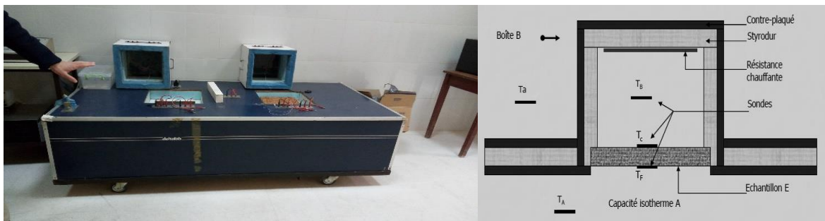
Figure 3.24 Boîte pour mesures de conductivité et de diffusivité thermique.
