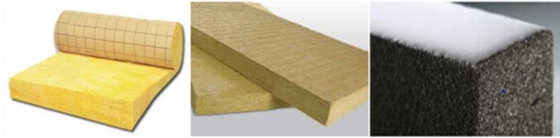
Figure 1.6 De gauche à droite, laine de verre, laine de roche, et cellulose [22].
