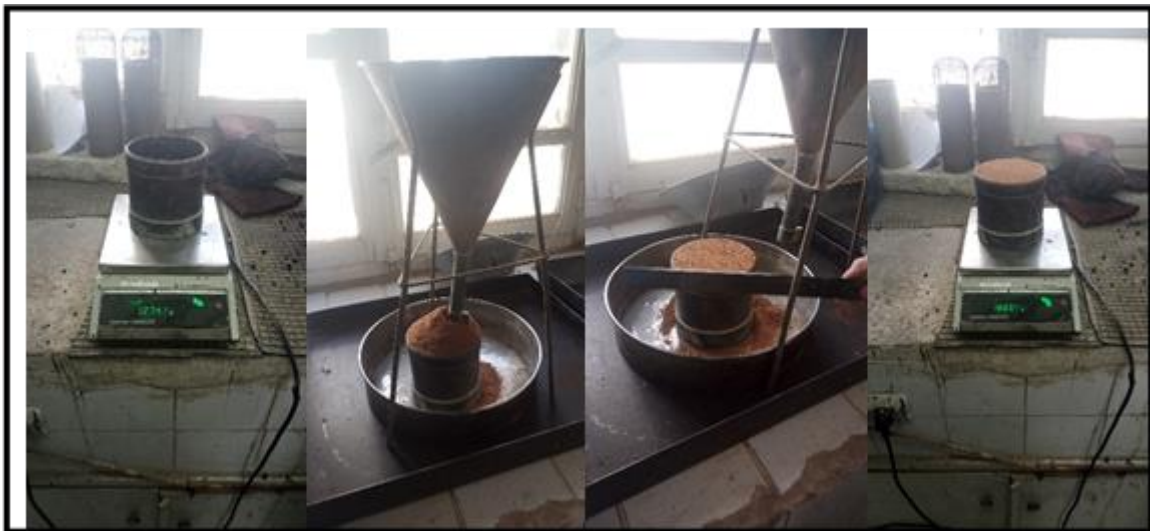
Figure 3.25 Etape de mesure de la masse volumique apparente d'une poudre de noyaux dattier.
