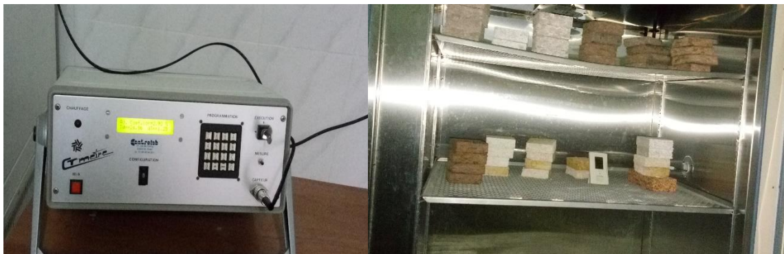
Figure B.2 CT mètre appareil de mesure de la conductivité thermique et chambre climatique permet de simuler différentes valeurs de température et d'humidité.
