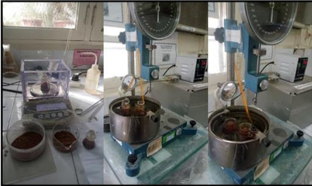
Figure 3.26 Processus de mesure de la densité en utilisant le pycnomètre et le bain thermostaté.
