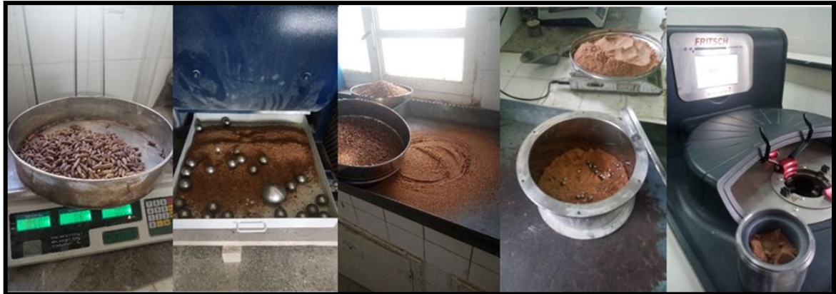
Figure 3.9 Affinement et miniaturisation de la taille des grains en fragment, puis en particules ensuite en poudre microscopique ultrafine \leq 80 nm
