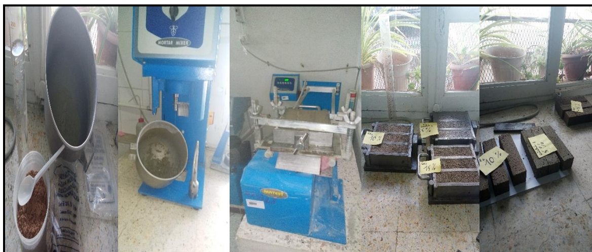
Figure 4.20 Processus d'élaboration des éprouvettes en matrice cimentaire combinée avec différentes concentrations en nanofibres celluliques (NFCn).
