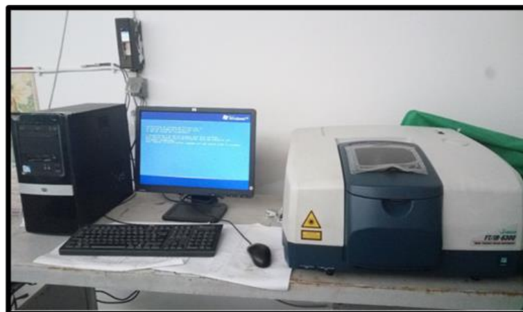
Figure 3.16 Spectromètres infrarouge FT-IR - 6300 dispose une gamme spectrale de 12400 spectres et une résolution de 0.4 à 0.07 \text{cm}^{-1} .
