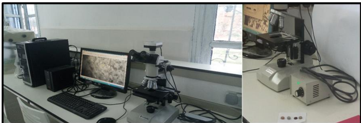
Figure 3.11 Visualisation métallographique des pastilles.
