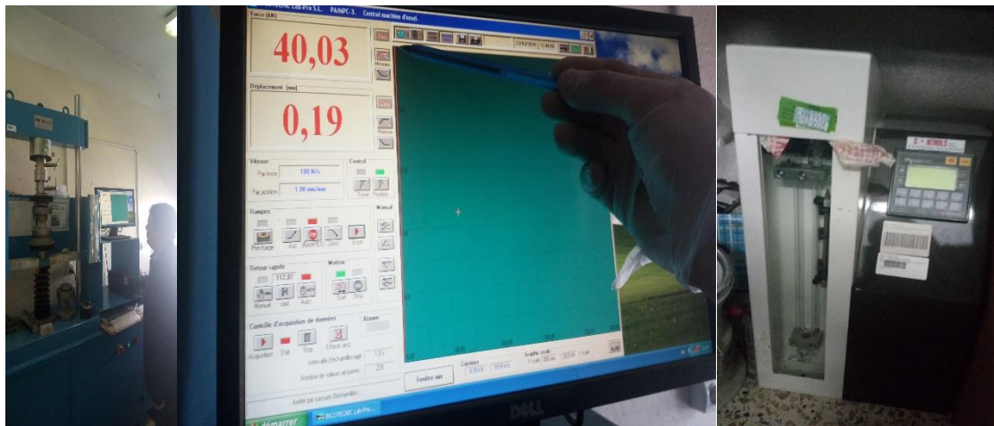
Figure D.3 représente le dispositif de mesure de compression et de perméabilité à l'air Blaine.
