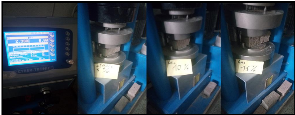
Figure 4.21 Mesures expérimentales de la résistance à la compression élaborées par l'appareil hydraulique Matest
