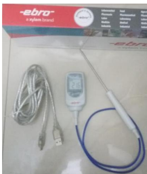
Figure 5.8 Thermocouple électronique des prises de mesures de températures surfaciques. (Ebro TTX 100)
