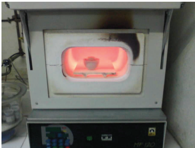
Figure IV.3 Préparation des adsorbants à base de boue par carbonisation
