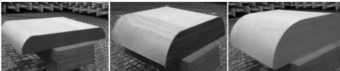
**Figure 4.27** : Panneaux à bords courbes utilisés pour l'expérience; les rayons des courbures sont de 10 cm, 20 cm et 30 cm, de gauche à droite. Source: Szela A et al ., 2019.
