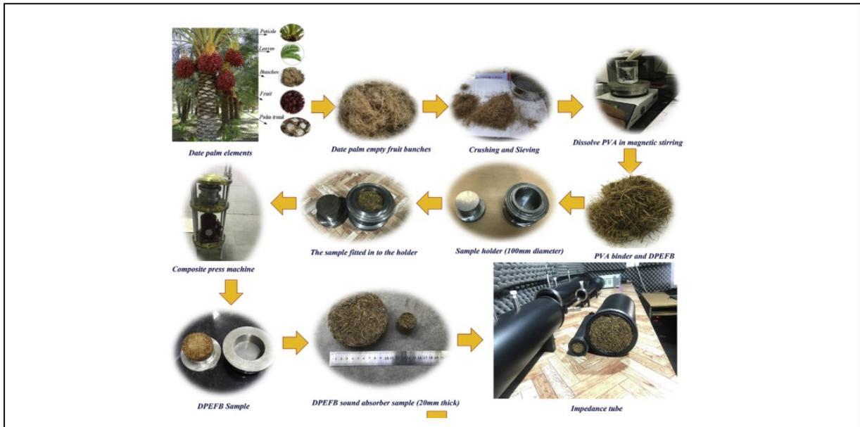
**Figure 4.16** : Préparation d'échantillons des fibres naturelles issues du palmier dattier vide. Source: Taban E et al., 2019
