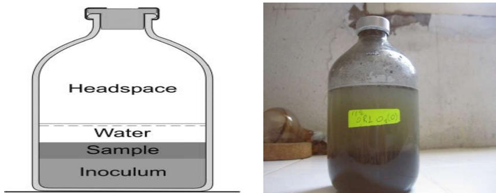
Figure III.1 : Le réacteur batch utilisé
