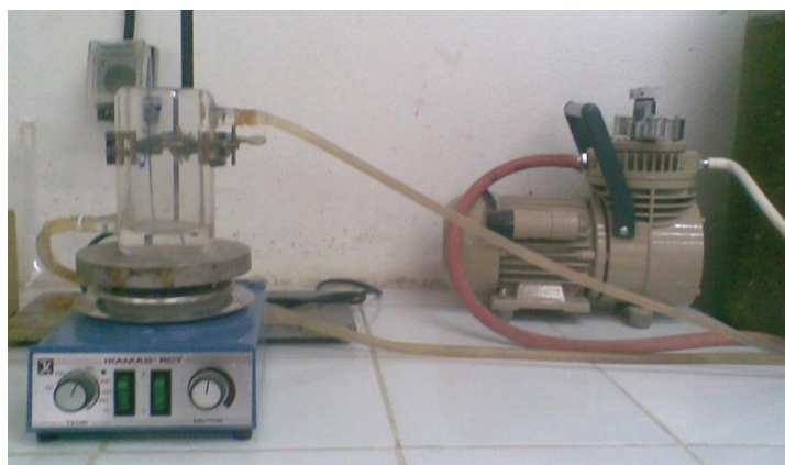
Figure 4.4 : Montage de la double enveloppe
