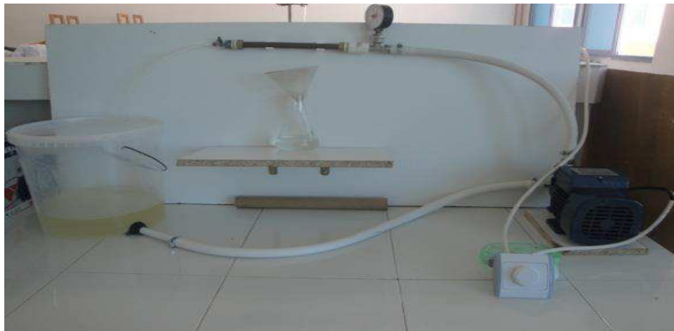
Figure IV-1 : Montage de microfiltration tangentielle (LIPE).
