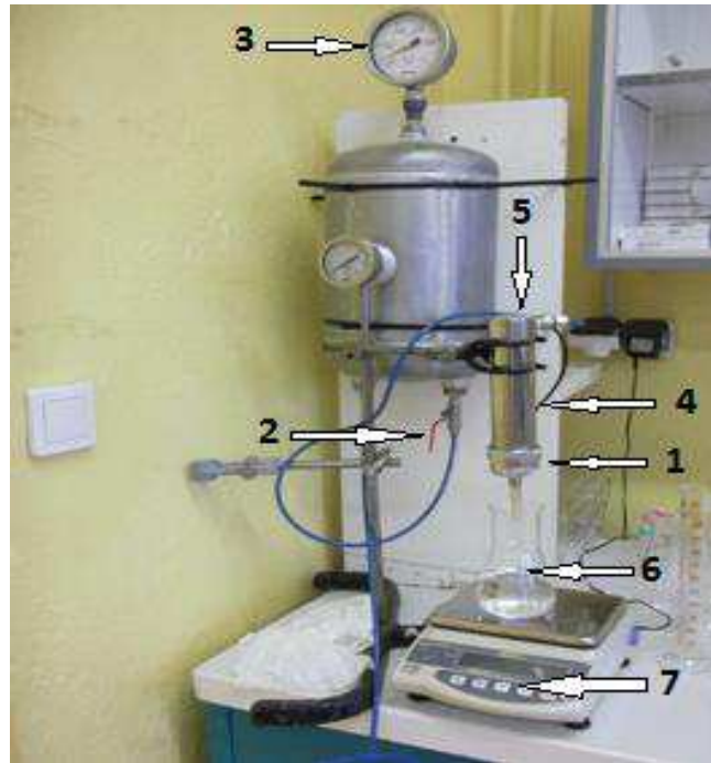
Figure IV-4 : Montage du pilote de microfiltration frontale (IEM).
