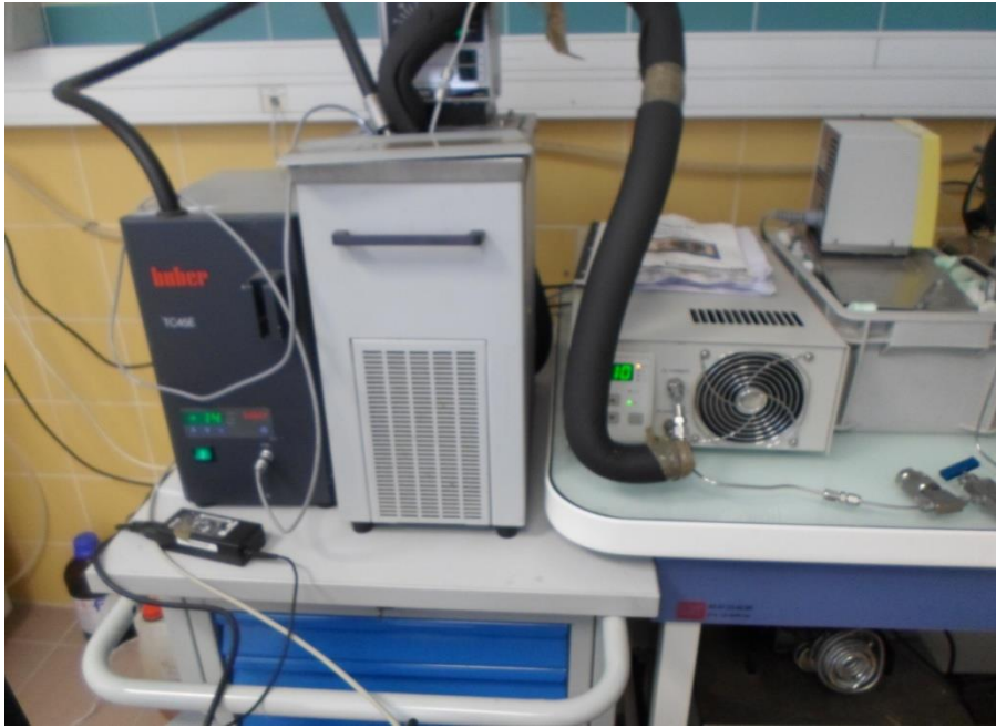
Pompe à droite / Bain thermo staté à gauche
