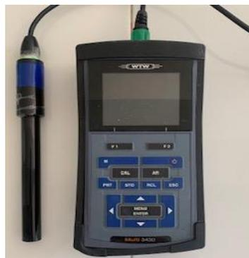
Figure 2. 18 conductimètre WTW multi 3430
