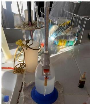
Figure 2. 11 titrage par la soude
