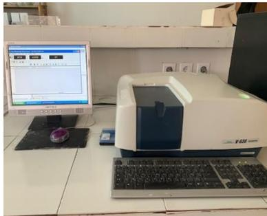
Figure 2. 16 spectrophotomètre
