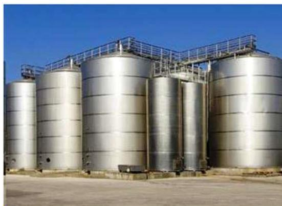
**Figure 1. 18** Les Fermenteur de production d'Oméga-3 à partir de microalgues
