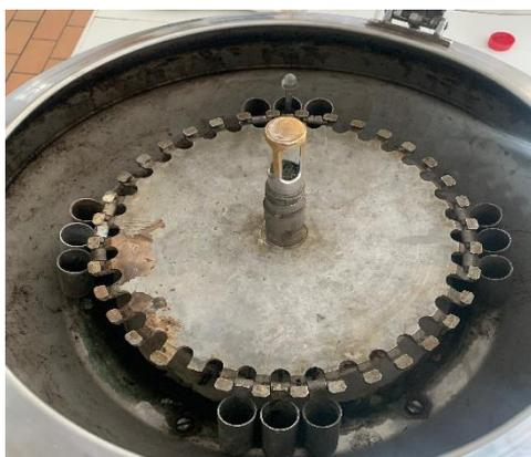
Figure 2. 14 centrifugeuse utilisée pour la quantification de la matière grasse.
