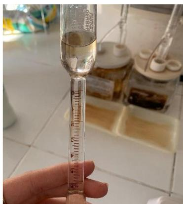
Figure 2. 13 butyromètre pour lait
