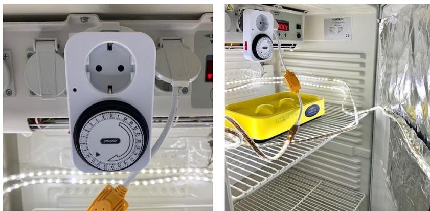
**Figure 3.3** Programmateur et installation de l'éclairage artificiel dans l'enceinte thermique.
