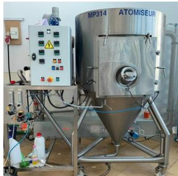
**Figure 2. 21** atomiseur utilisé se localisant dans la Faculté de Génie des procédés.
