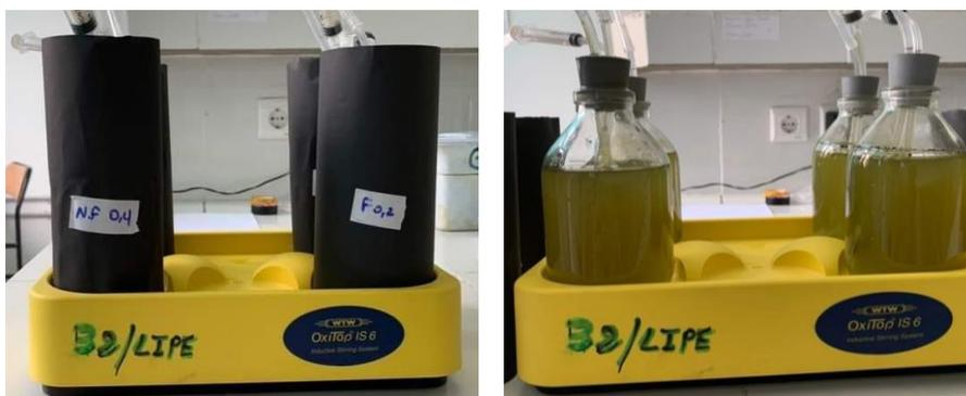
**Figure 3.5** Réacteurs en condition chimiotrophe pour les échantillons filtré et non filtré
