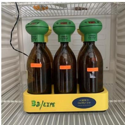
Figure 2. 25 OXITOP utilisés pour la mesure de la DBO<sub>5</sub>
