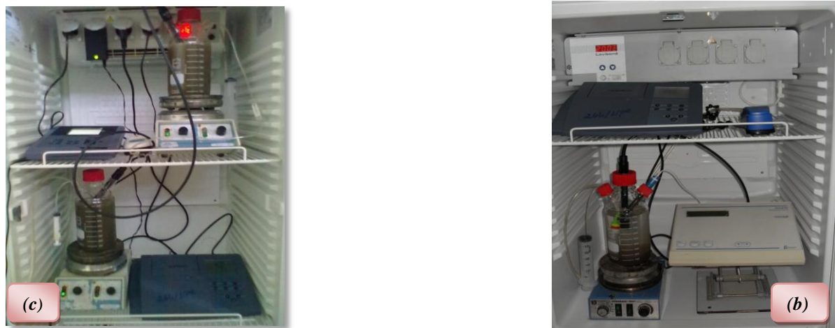
Figure IV .14. Les montages expérimentaux utilisés dans les études respirométriques menées (a) premier montage respirométrique utilisant un enregistreur graphique (b) montage respirométrique utilisant des oxymètres à acquisition automatique (c) montage respirométrique utilisé dans les études comparatives.
