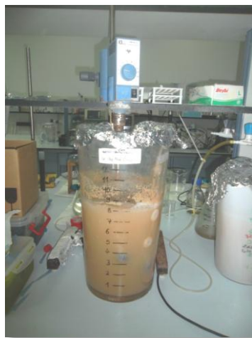
Figure .V. 38. Photo du micro pilote utilisé pour l'alimentation des tests respirométriques
