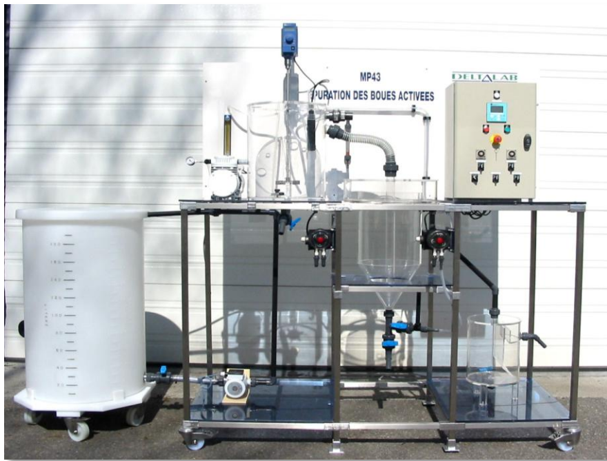
Figure VI.1. Photo de la station pilote des boues activées utilisée MP43
