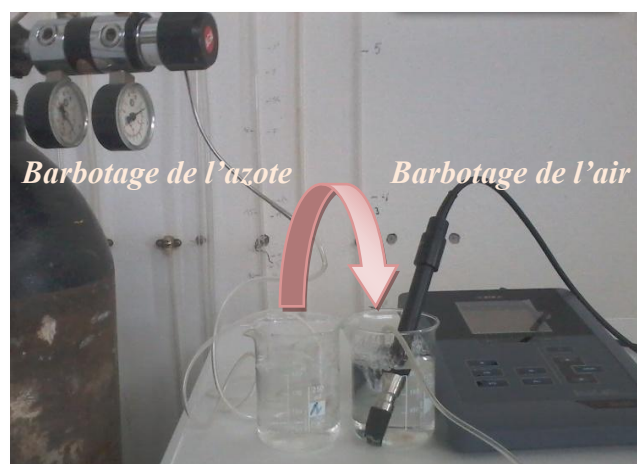
Figure IV.15. Procédure expérimentale pour la détermination du temps de réponse des sondes d'oxygène utilisées
