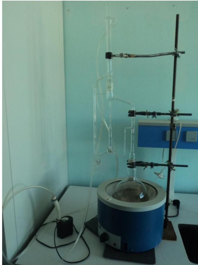
**Figure A. 2 :** Montage d'hydrodistillation utilisé dans l'extraction (Witeg NS29.2/32).
