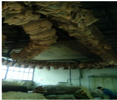
Figure 2. Séchage par mise en vent (Photo prise de la tannerie DMD s.p.a. Solofra, Italie)
