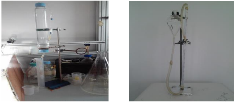
Figure 2. Techniques de mesure du biogaz par déplacement d'eau
