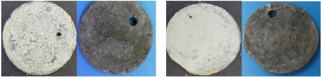
Pièce en plomb altérée par vapeurs de la solution 0.3M acide acétique
