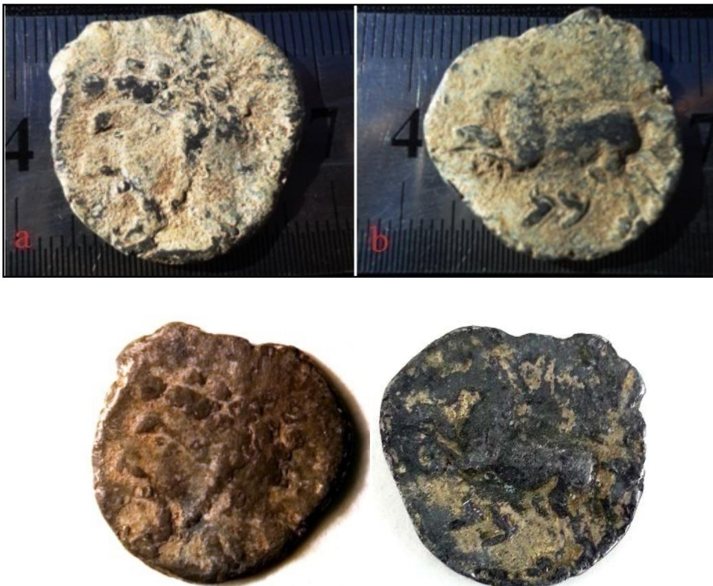
**Figure 28** : Pièce M<sub>2</sub> avant et après traitement électrochimique **A** face Avers **B** face Revers.
