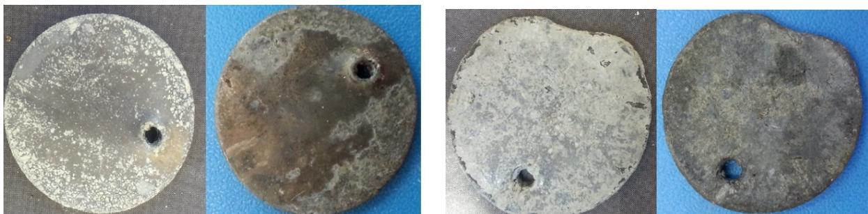
Pièce en plomb altérée par vapeurs de la solution 0.3 M, a) éthanal, b) acide propanoïque
