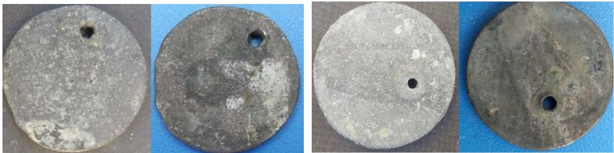
Pièce en plomb altérée par vapeurs de la solution 0.3 M acide formique
