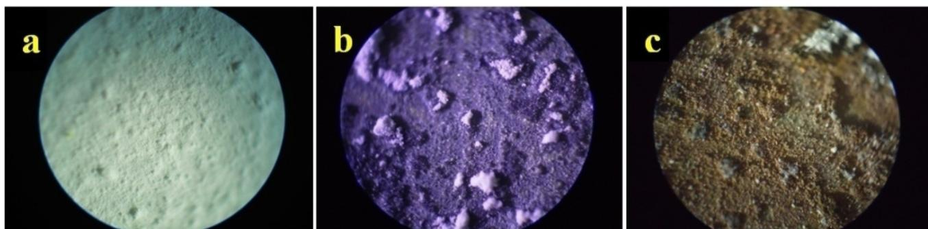
**Figure 20** : Observation par microscope optique (120x) de la surface d'électrode de platine recouverte d'une couche d'**a** cérosite avant polarisation **b** après polarisation cathodique à  $-1.10$  V/ECS durant 2.00 heures **c** après polarisation anodique en régime potentiodynamique de  $-0.50$  à  $1.40$  V/ECS à une vitesse de balayage de  $1.00$   $\text{mVs}^{-1}$ .
