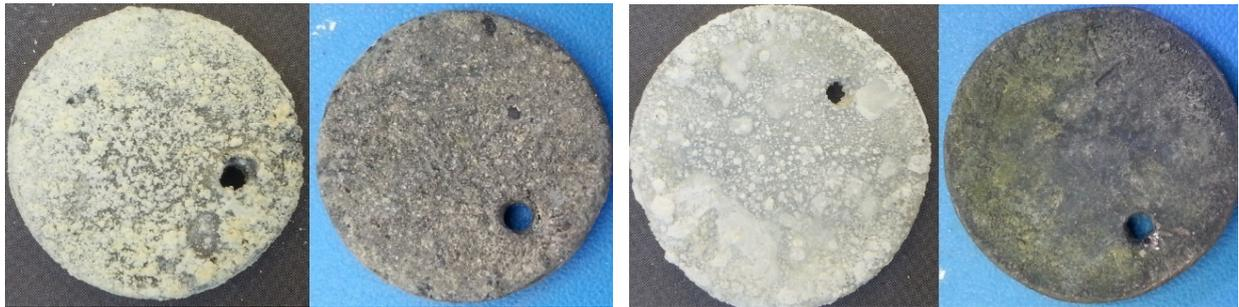
Pièce en plomb altérée par vapeurs de la solution 0.03M acide acétique
