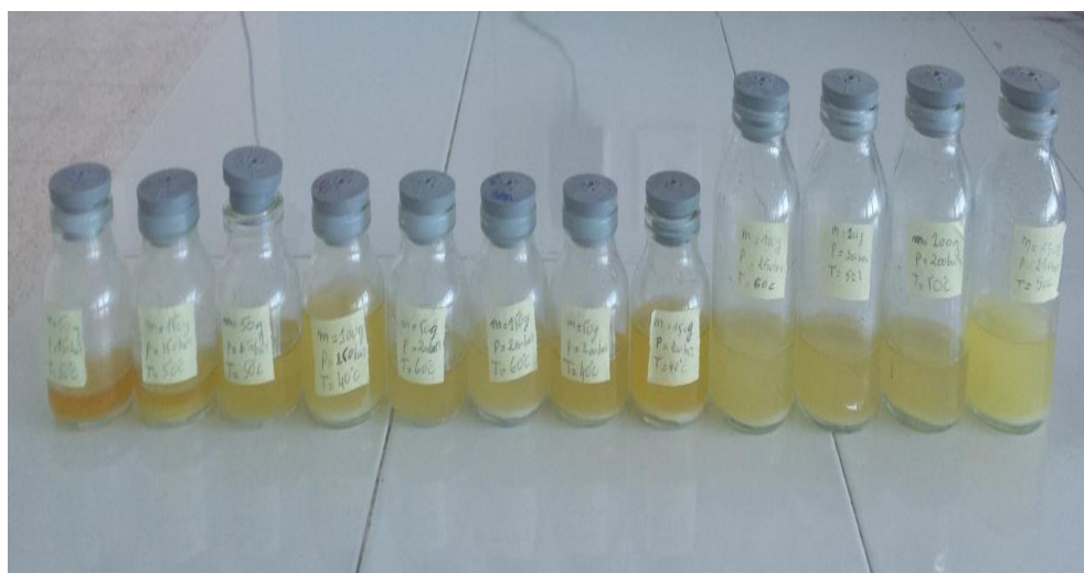
Figure AIII.1. Photographie des extraits de graines de sésame obtenus par CO 2 supercritique.
