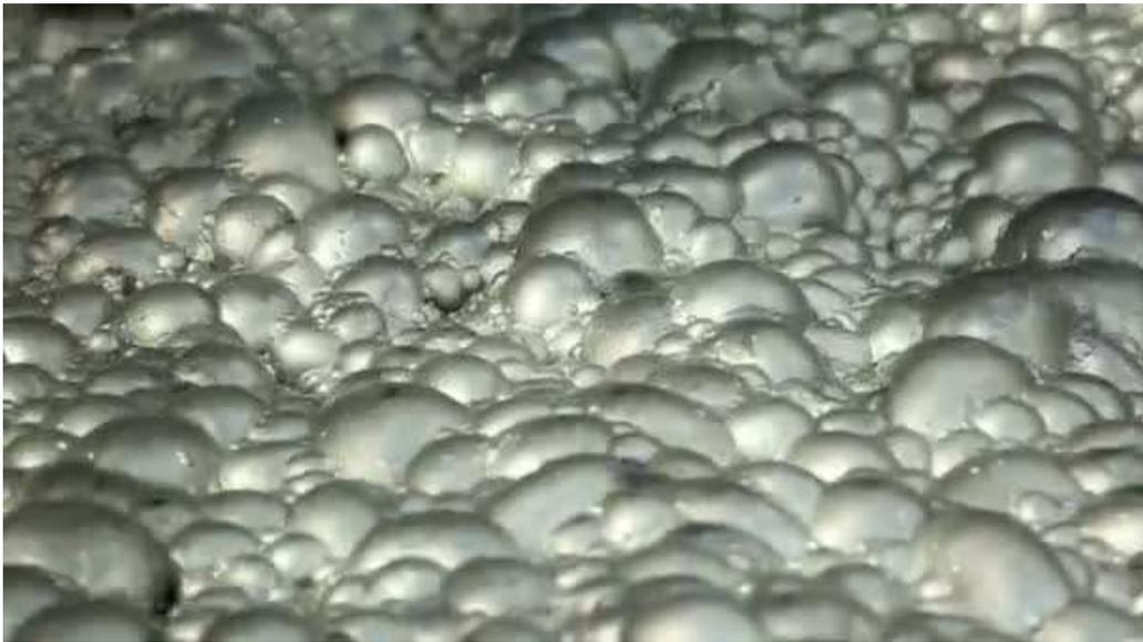
**Figure II.13: Photo de l'écume : Bulles d'airs chargés lors de la flottation.**
