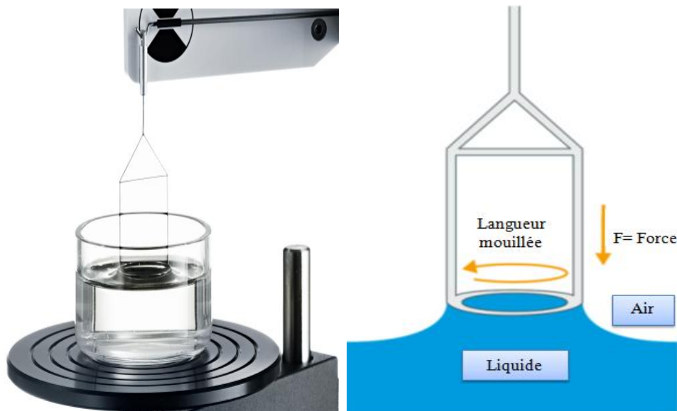
Figure 4.9 : Schéma illustrant la mesure de la force maximale nécessaire pour détacher un anneau de la surface d'un liquide
