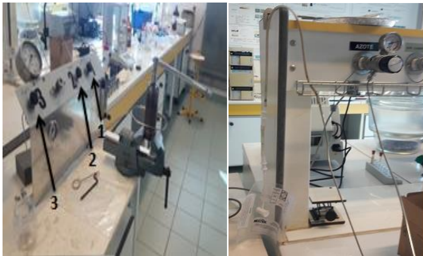
Figure 3.10. Protocole de récupération de gaz produits par gazéification en eau supercritique du glycérol.
