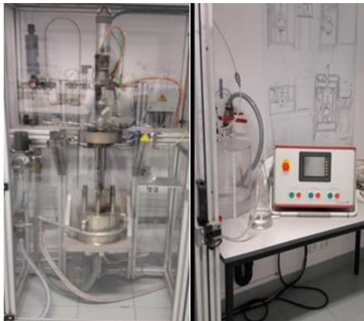
Figure 1.9. Réacteur discontinu de 500mL pour la gazéification hydrothermale, du centre RAPSODEE à l'école des mines d'Albi.
