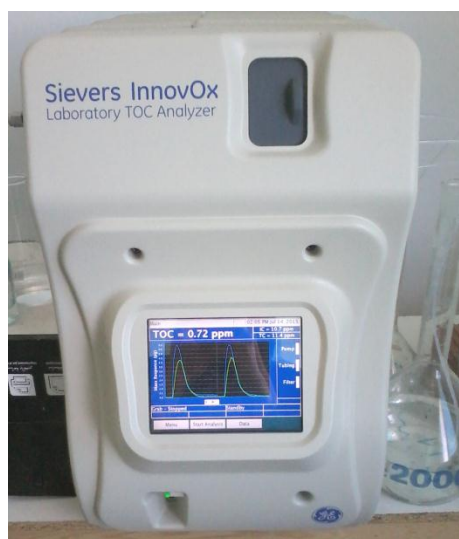
Figure 2.2. Analyseur du carbone total, carbone inorganique et le carbone organique total modèle « laboratory TOC analyser sievers innovox »
