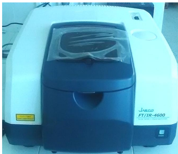
Figure 2.6. Spectroscopie infrarouge modèle « Jasco FT/IR-4600 »
