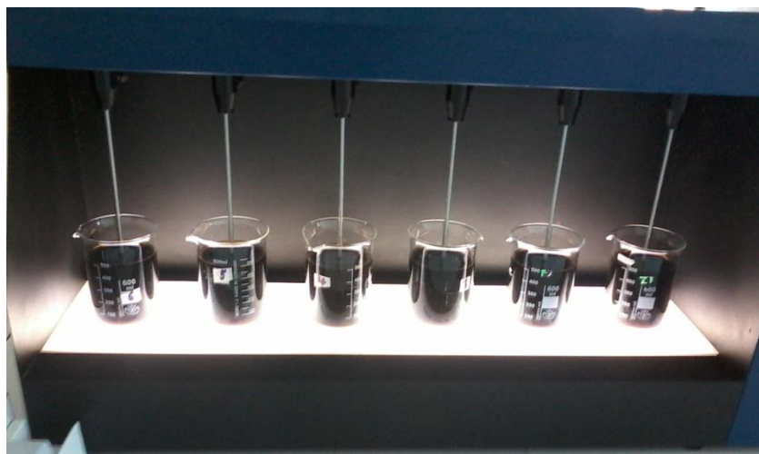
Figure 2.3. Jar test modèle de six série d'agitateurs à lame
