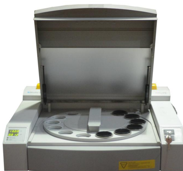
Figure 2.7. Spectrophotométrie de fluorescence X modèle « Minipal2 Xray spectrometer Panalytical »
