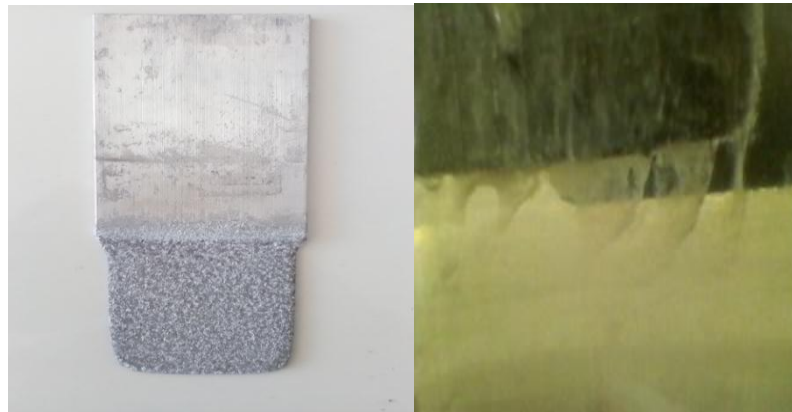
Figure 3.11. Anode sacrificielle utilisé dans le processus d'EC pour l'élimination des nitrates
