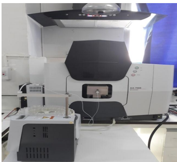
Figure 2.8. Spectrophotomètre d'absorption atomique en flamme « atomic absorption spectrophotometer SHIMADZU AA-7000 »
