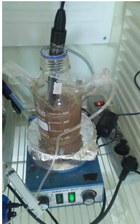
Figure 2.5. Dispositif expérimental de respirométrie
