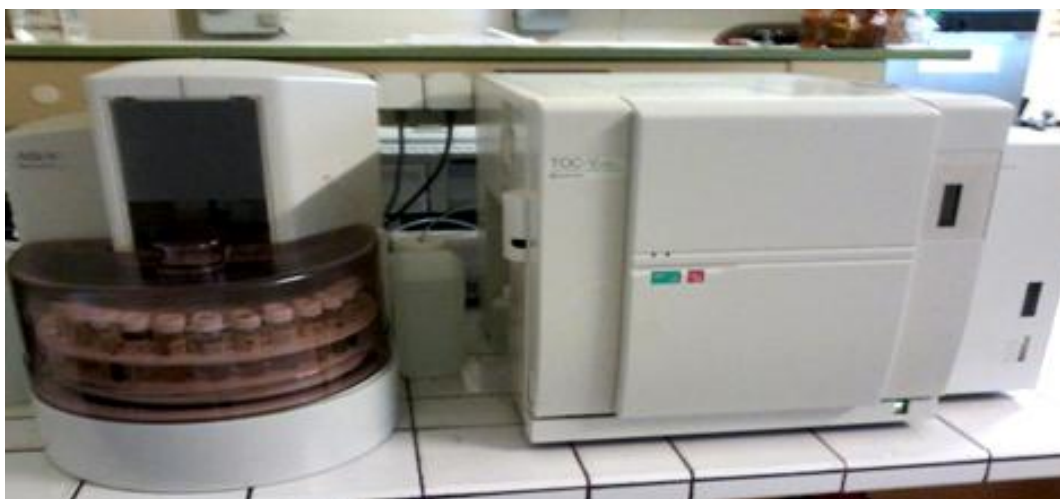
Figure 2.1. Analyseur d'azote total et du carbone organique total modèle « Shimadzu TOC Autosampler ASI-V »
