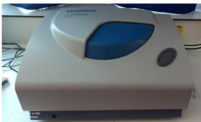
Figure 4.8. Zêta sizer SZ-100 (Horiba nano particule analyser)
