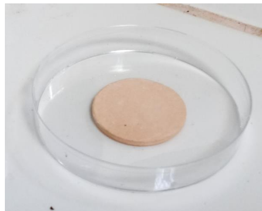
Figure 4.34 : Support couvert par polyélectrolytes (+) et (-)
