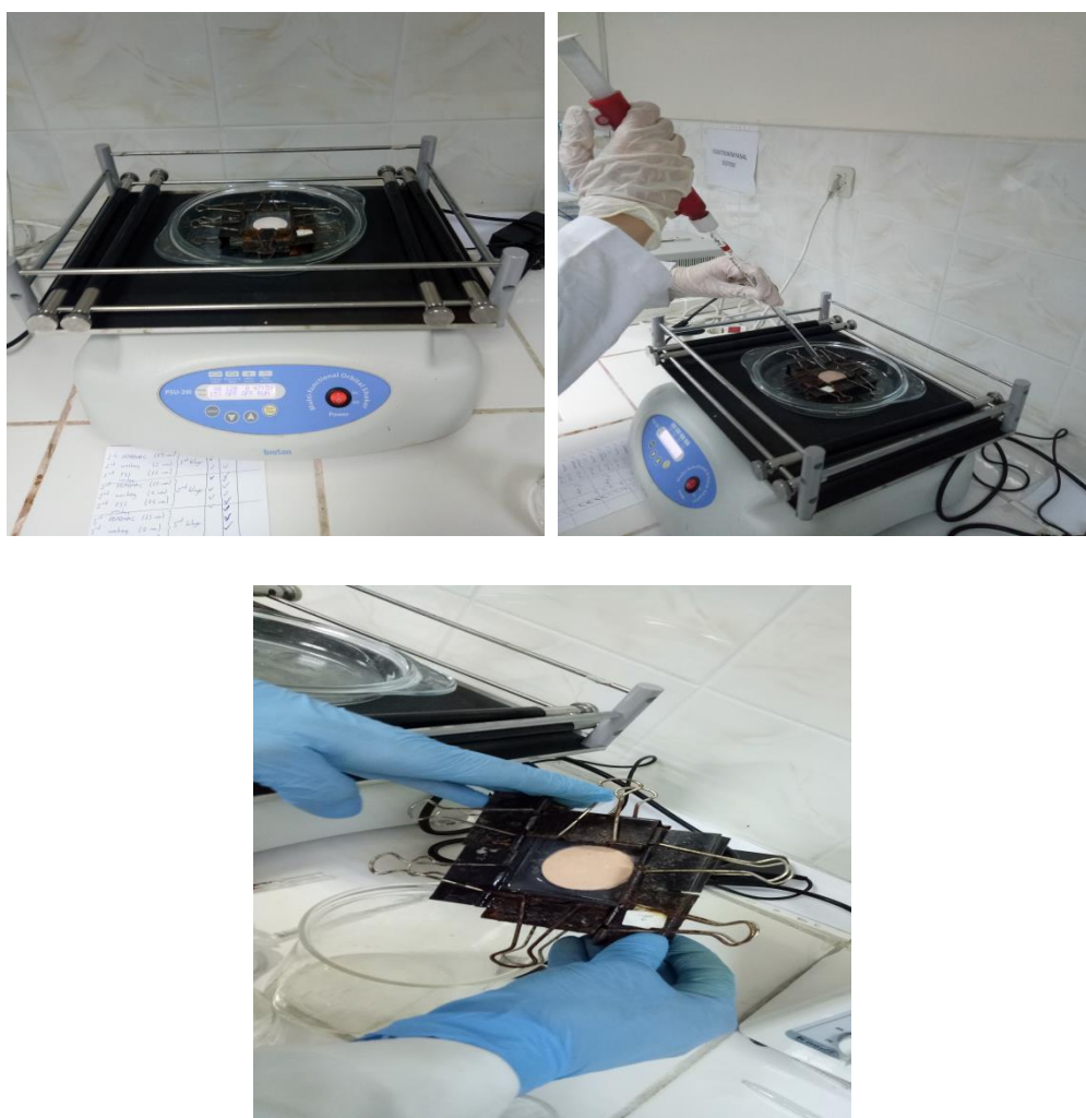
Figure 4.32 : Procédure de préparation d'un support à double couche (BiLayer)
