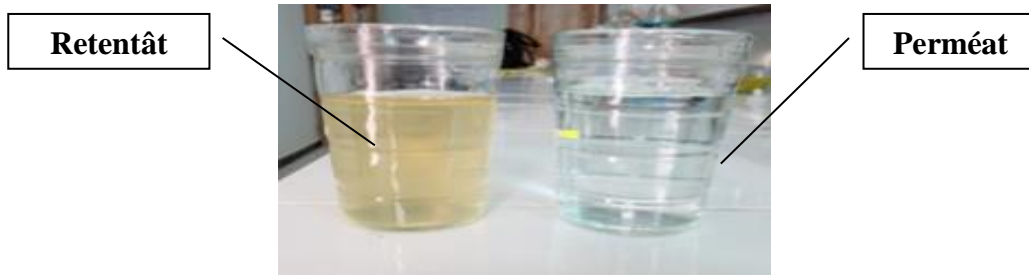
Figure 4.18 : Aspect de la couleur du retentât et du perméat après filtration de l'eau brute
