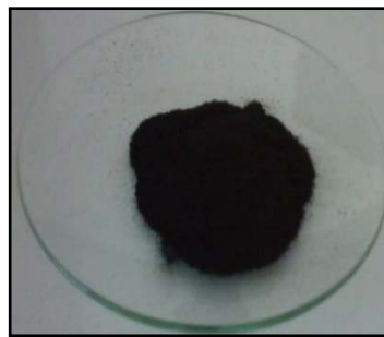
Figure 4.12 Les coquilles d'œufs calcinées (COC)
