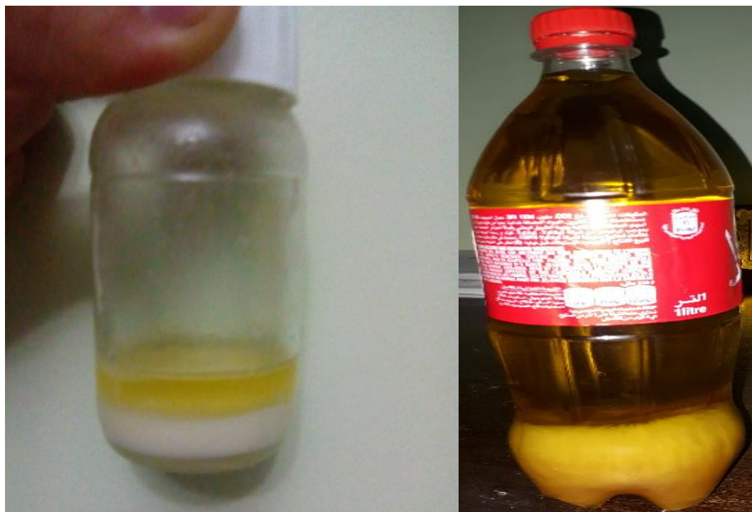
Figures 3.16: Cire présente dans une huile extraite: a) par CO 2 -SC, b) par Pressage à froid.
