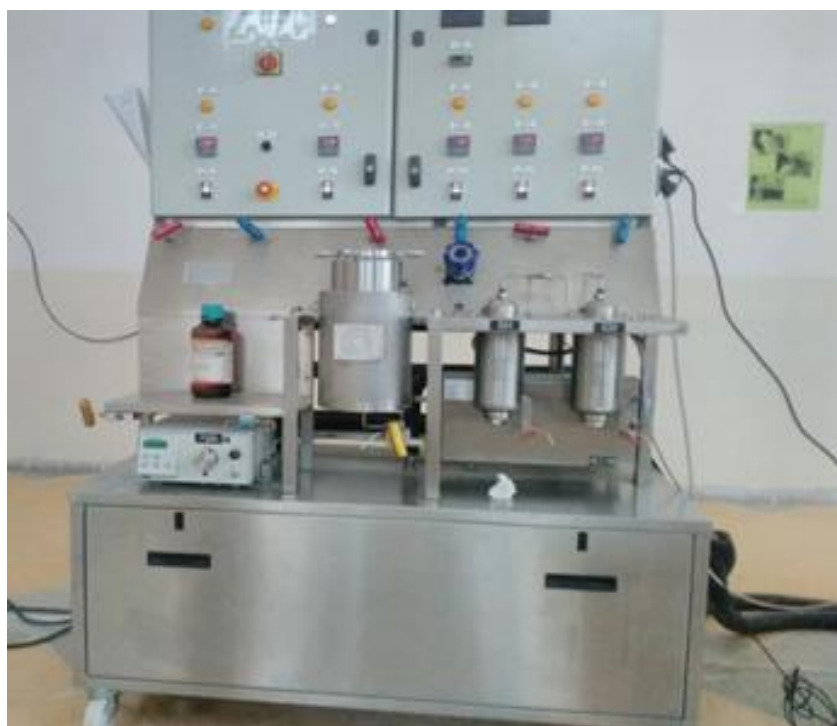
Figure 2.5 : Pilote d'extraction par fluides supercritiques au niveau du LIPE.
