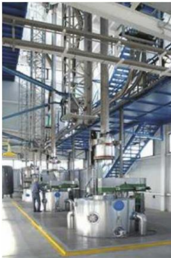
Figure 1.6 : Unité industrielle de désacidification des huiles par CO 2 supercritique (Espagne).
