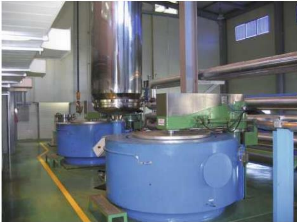
Figure 1.5 : Unité industrielle d'extraction par CO 2 supercritique des huiles alimentaires (Natex, Allemagne).
