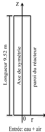
Figure 2. 9 : Modèle bidimensionnel pour le réacteur tubulaire.
