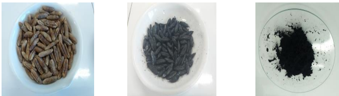
Figure 3. 5 : Préparation du charbon à partir des noyaux de datte (NDC).
