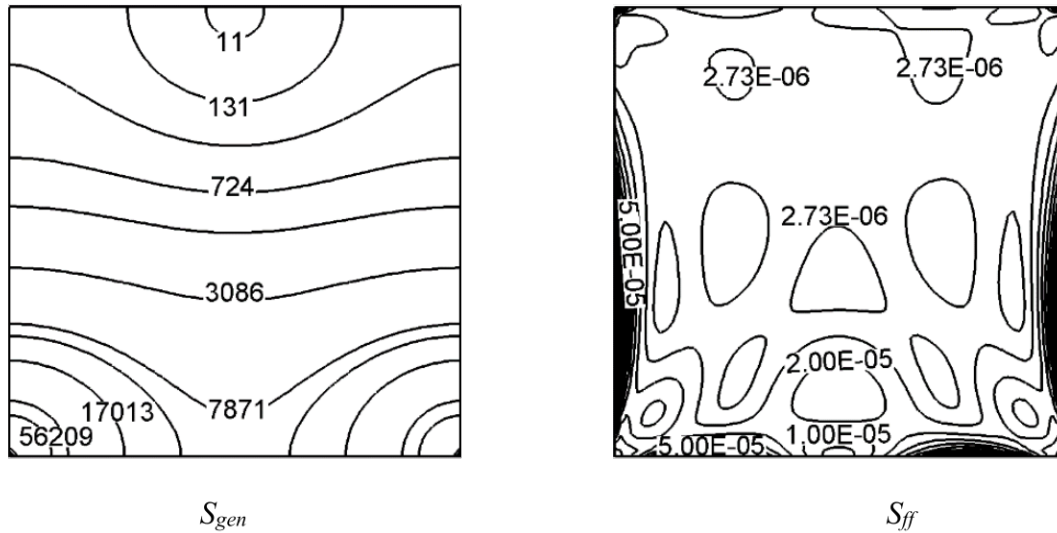
Figure 1.11 : Contours de la génération d'entropie S_{gen} (côté gauche) et la génération d'entropie due à la friction du fluide S_{ff} (côté droit) pour Gr=10^4 , Pr=0.015 et Re=1 .
