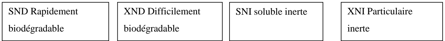
Figure II-4 Composants de l'azote dans l'ASM1
