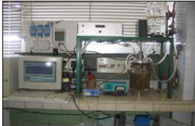
**Figure II.4.** Exemple d'un respiromètre utilisé en laboratoire. [5]
