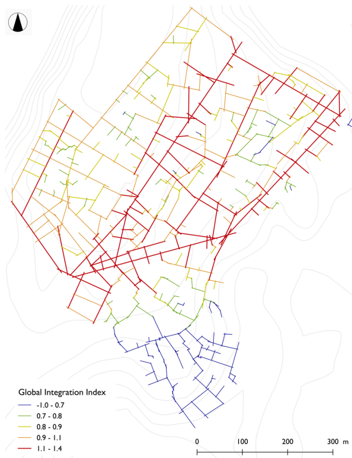
Figure 5.9: Carte axiale représentant l'indice de l'Intégration à l'échelle globale ( r = n ), Auteur (Depthmap & QGIS).
