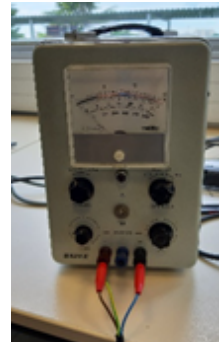
(b) Bloc d'alimentation électrique pour le ventilateur d'extraction
