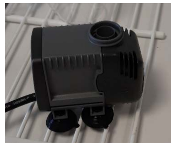
(d) pompe à eau immergée
