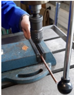
(a) perçement des trous du système de distribution de l'eau
