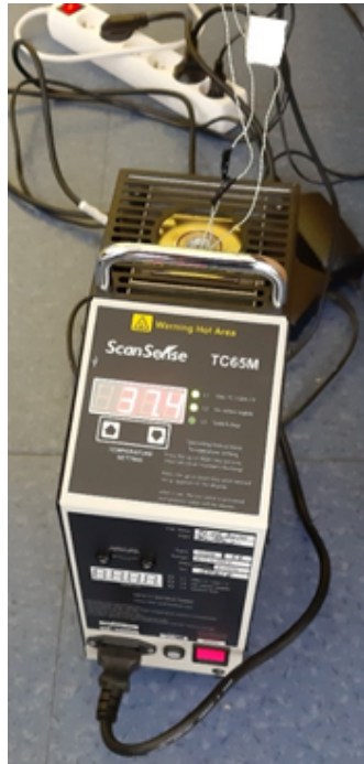
(g) Calibrage des thermocouples Scan Sense TC65M (h) Thermo-anémomètre à fil chaud Kimo VTS
