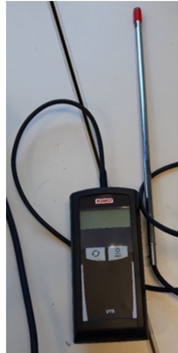
(g) Calibrage des thermocouples Scan Sense TC65M (h) Thermo-anémomètre à fil chaud Kimo VTS
