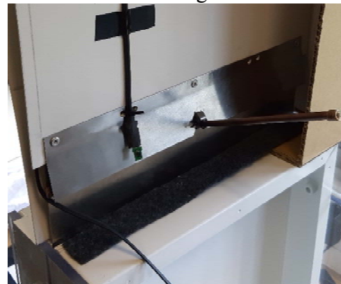
(e) capteur d'humidité sortie canal humide
