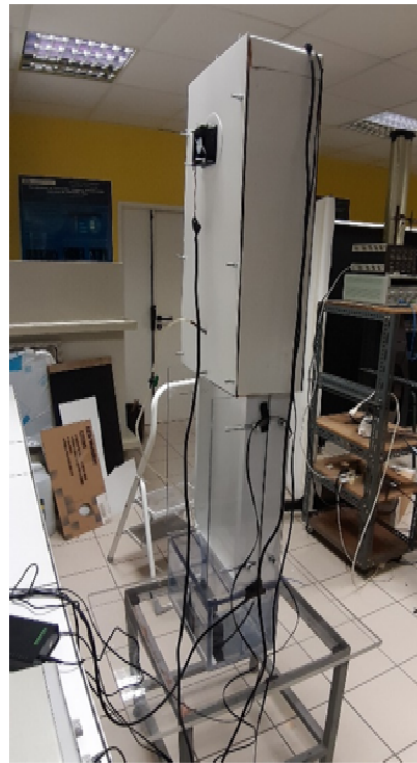
(l) mise en place du réservoir d'eau et des câblages d'alimentation électrique
