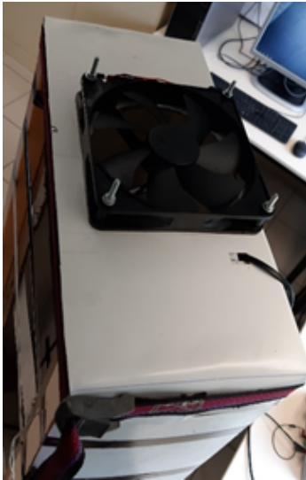
(i) pose du ventilateur d'alimentaion
