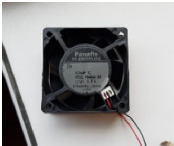
(c) ventilateur de soufflage
