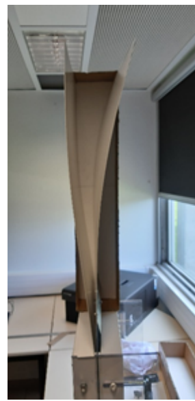
(f) mise en place des parois de guidage de l'air
