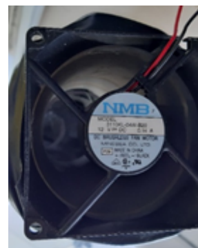
(f) ventilateur d'extraction
