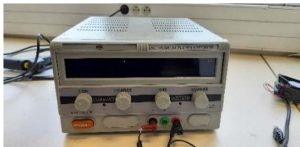
(a) Bloc d'alimentation électrique pour les ventilateurs d'admission et de soufflage
