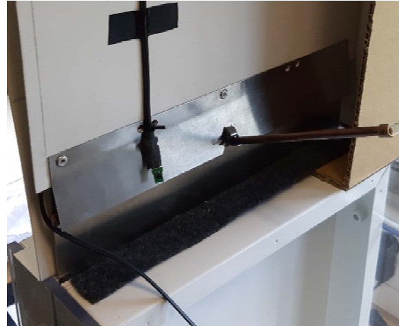
(h) mise en place du distributeur d'eau dans le support de soutien
