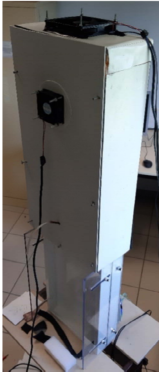
(k) pose du caisson de protection système et du ventilateur d'extraction de l'air
