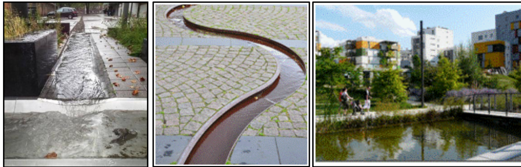
Fig .II.8 : L'eau ruisselant en surface dans les espaces ouverts augmente le flux latent ( http:// www.panoramio.com ).
