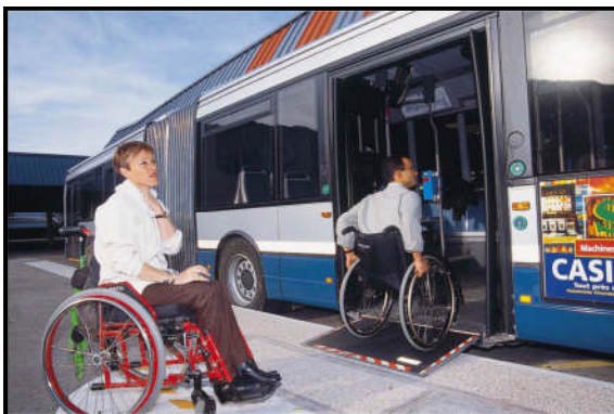
Photo 09: Rampe d'accès aux autobus à Grenoble
