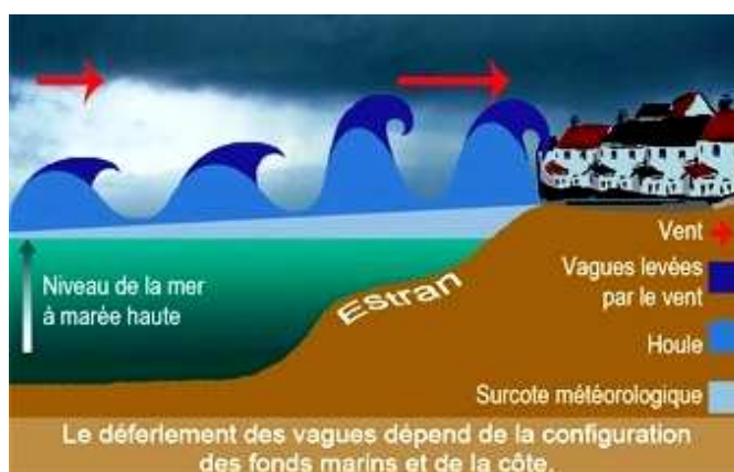
Figure N° 46: Schéma descriptif d'une submersion marine
