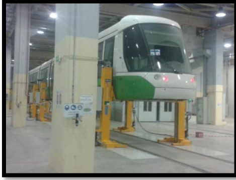
صورة رقم (45): رفع الترامواي بالحوامل الهيدروليكية
