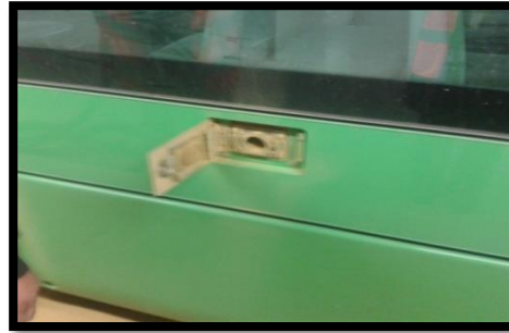
صورة رقم(47) : عملية تعبئة الرمل لرفع درج الاحتكاك بين العجلات والسكة.
