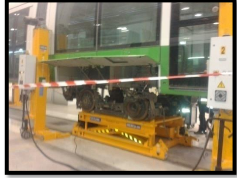
صورة رقم (44): نزع المحرك بسهولة
