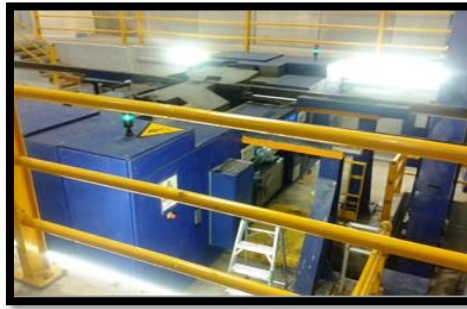
صورة رقم(46): آلة ميكانيكية (مفرزة) لتعديل قطر عجلات السكة.
