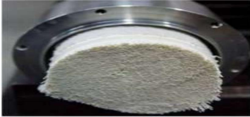
**Figure 2.9:** module à fibre creuse.[46]
