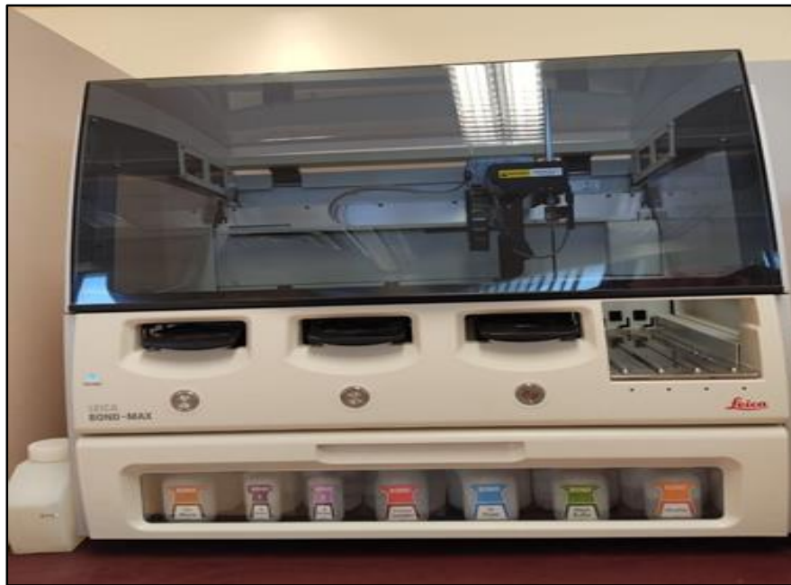
Figure 66 : Automate de coloration d'immunohistochimie (source : laboratoire d'anatomie et de cytologie pathologiques HMRU Constantine).
