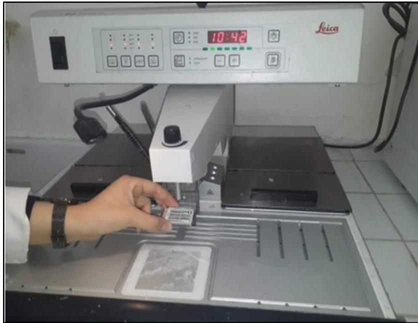
Figure 51 : Enrobage, création du bloc de paraffine (source : laboratoire d'anatomie et de cytologie pathologiques EHS Daksi. Constantine. 2015-2020)
